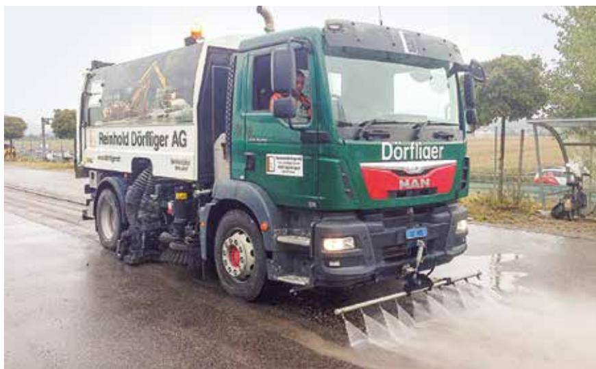
*Die neue Strassenwischmaschine mit dem Frontwaschbalken im Einsatz.*
