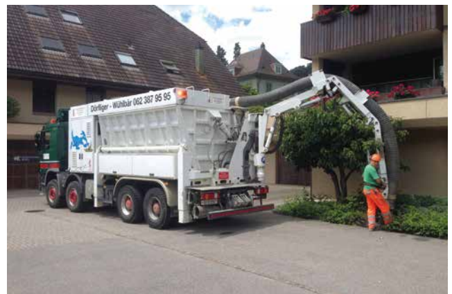
32 Tonnen Einsatzfahrzeug mit 8 m 3 Innenvolumen, hydraulischem Saugarm, ferngesteuert
