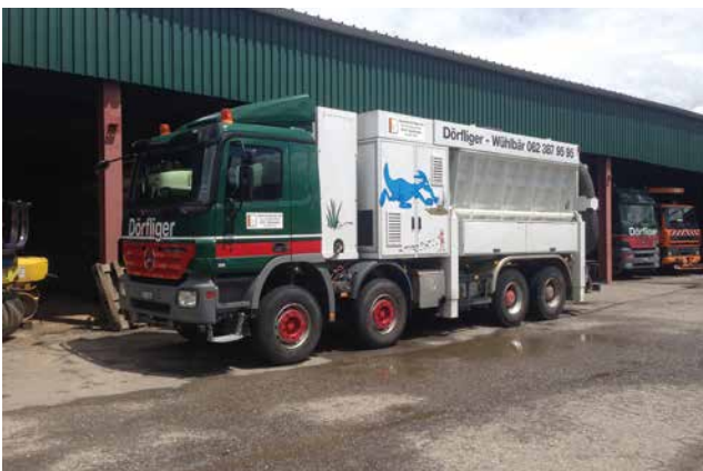
32 Tonnen Einsatzfahrzeug mit 8 m 3 Innenvolumen, hydraulischem Saugarm, ferngesteuert
